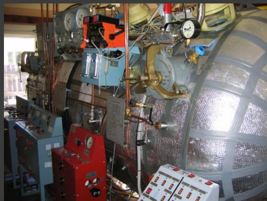
100-метровый барокомплекс ПДК-2У - прототип барокомплекса "Спаситель" ЗАО "СКБ ЭО при ИМБП РАН"
