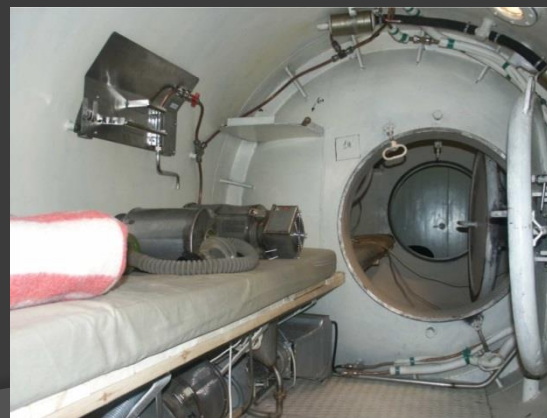
100-метровый барокомплекс ПДК-2У - прототип барокомплекса "Спаситель" ЗАО "СКБ ЭО при ИМБП РАН"
